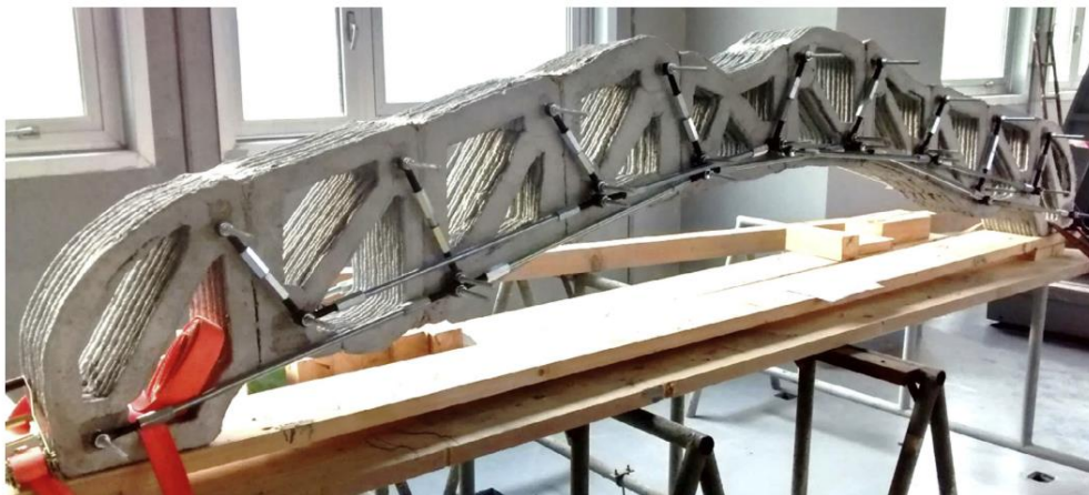
Obr 3 Příčný trám s instalovaným systémem externích výztuží
