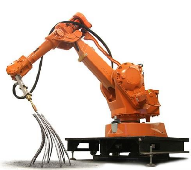
Obr 6 MX3D Anti-gravity print pomocí svářečí hlavy
