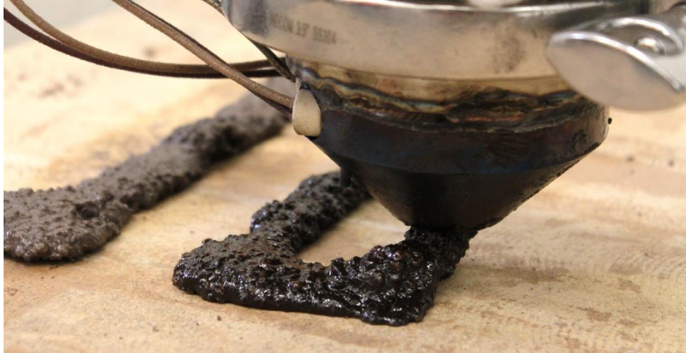
Obr 20 Testovací nános z první sady pokusů, teplota směsi 290 °C, výška vrstvy 10 mm
